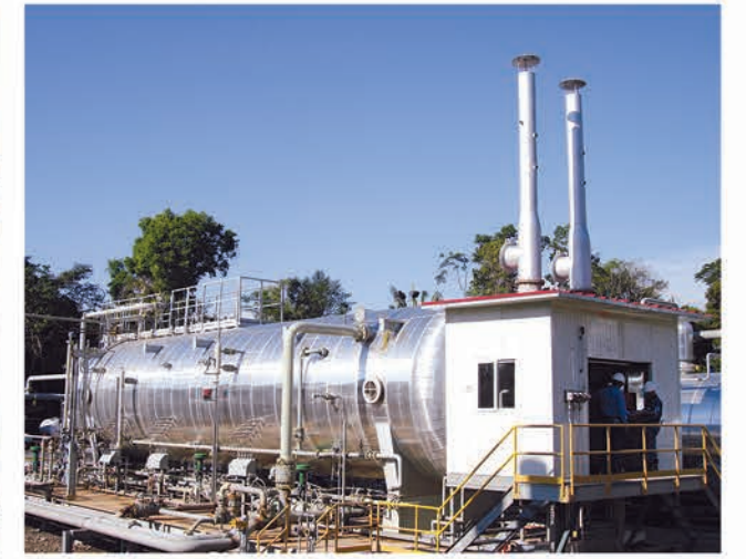
▼ 向厄瓜多尔石油公司提供组合式加热分离器 Provide Combined Heating Separator for Ecuador Petroleum Company
